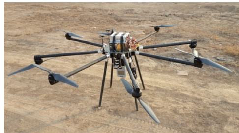
图 2 挂载 \gamma 谱仪和气溶胶采样器的无人机
